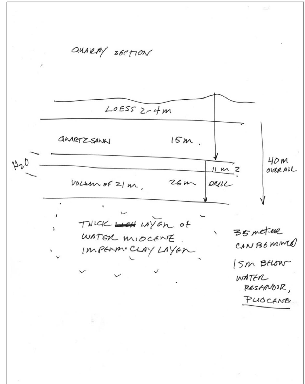
Fig. 121. Für das Vorkommen in Soufflenheim wird der Querschnitt des Geländes wie folgt beschrieben, fax transmission from Friedrich Quarzsandwerke, with stratigraphic information of the quartz sand used in the Rapson Group Glass. 2006.
